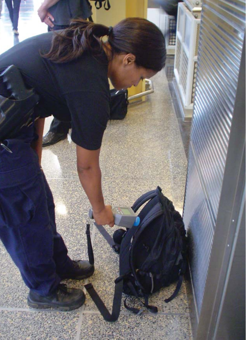
左： 检查行李辐射。右图： 基于车辆（顶部）和手提(底部)核探测系统。
