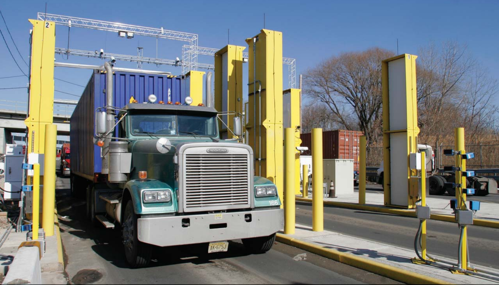
一辆卡车通过门式辐射监测器。这样的设备被用于边境和核设施检查。
